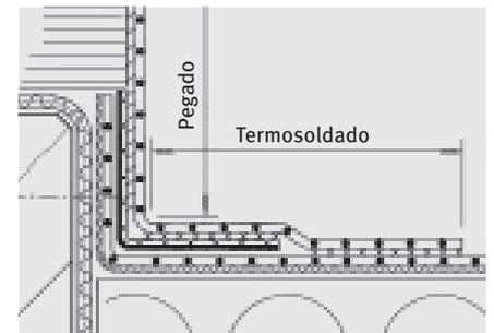
La banda de cierre VSKA se produce con uno o dos solapes laterales para realizar la unión termosoldada. Por ello, disponemos de material homogéneo entre banda de cierre EVALON® VSKA e impermeabilización con EVALON®.
